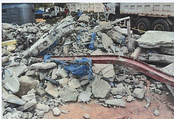
Figura 8: Perfil metálico de refuerzo bajo viga encima del escenario, nótese la placa de acero referida
